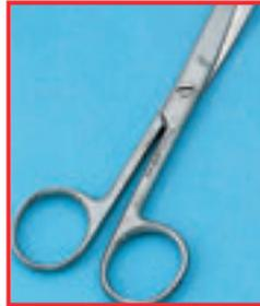
Ciseaux avec piqûre de corrosion
