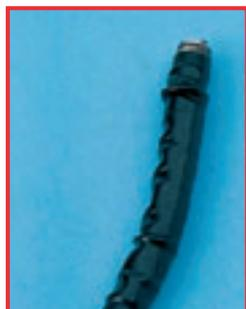
Gonflement à l'extrémité distale d'un fibroscope
