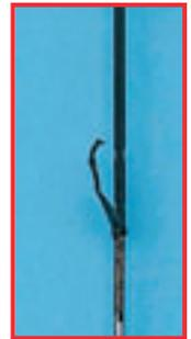
Isolation endommagée sur un instrument HF
