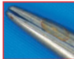
Attaque acide des soudures et des couche intermédiaire de métal avec forte usure, suite au dommage.
