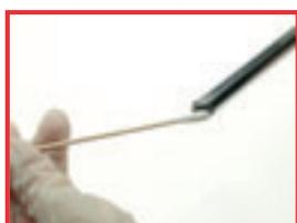
Nettoyage d'un objectif d'endoscope
