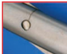
Fissure sur le filetage de la vis
