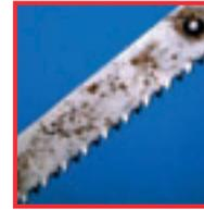
Dépôt de rouille sur une lame de scie chromée en acier non allié.
