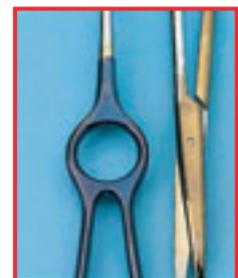
Coloration des instruments due à la silice !
