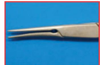
Déformation due à une manipulation non conforme
