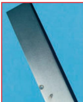
Attaque de corrosion sur ciseaux
