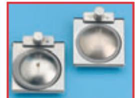
Soupape à clapet non étanche d'un trocart par gonflement des joints suite au contact avec de l'huile.
