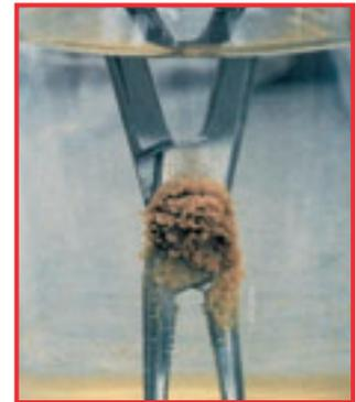
Formation de rouille due à l'immersion durant plusieurs heures dans une solution d'eau salée
